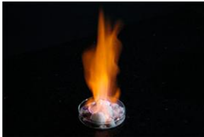
▲ 燃焼するメタンハイドレート（人口） 出典：メタンハイドレート資源開発研究コンソーシアム
