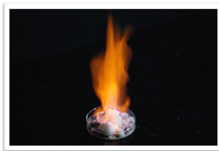
▲燃焼するメタンハイドレート（人口） 出典：メタンハイドレート資源開発研究コンソーシアム
